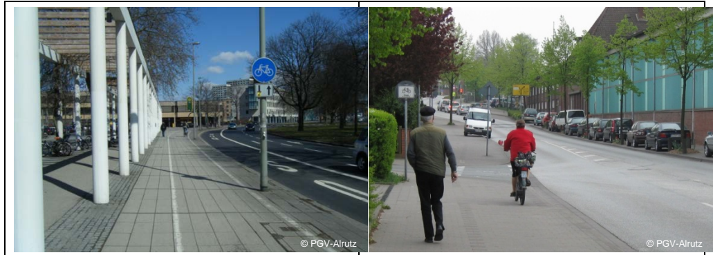
Abb. 2-5: Zweirichtungsradwege mit Benutzungspflicht (links) und Benutzungsrecht (rechts) für die Fahrtrichtung links
