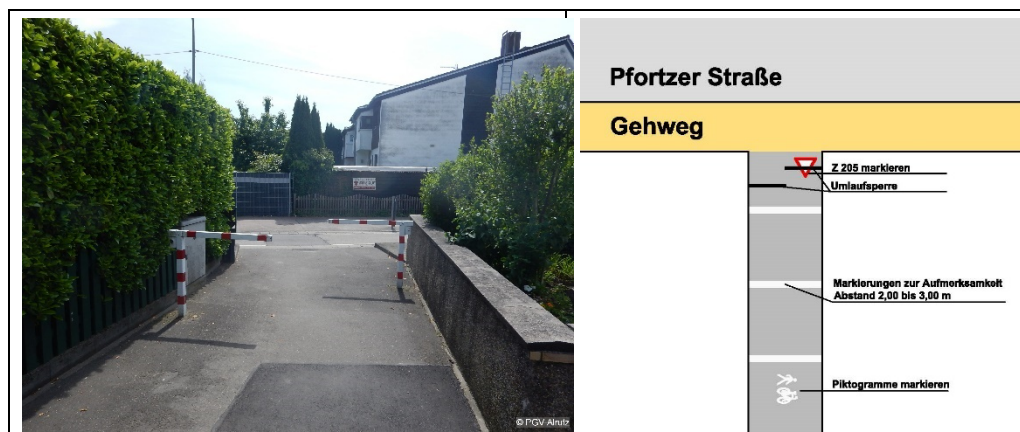
Abb. 4-1: Sicherung von Querungsstellen mit Sichtbehinderung (links Bestand Pfortzer Straße, rechts Prinzipskizze für Markierungen)
