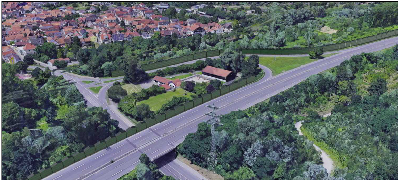
Abbildung 37 Fotocollage einer Lsw mit Pv-Aufsatz aus Google Earth 3D
