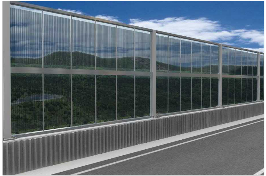
Abbildung 2 semitransparente photovoltaische Lärmschutzelemente (Visualisierung)
